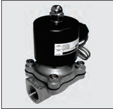
Válvula de processo para propósitos gerais, 2/2 vias na versão normalmente fechada (NF). As válvulas de processo modelo VPAI podem ser utilizadas com: Ar comprimido, Gases inertes, Água e Óleos; Entre outros líquidos.
